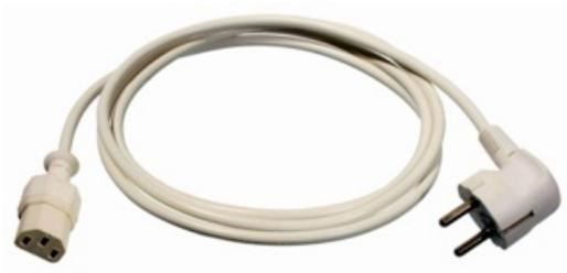
Câble de raccordement pour appareils froids -70°C, 2m H05VV-F3G0.75 blanc
