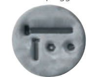
Bereiding ter plaatse van kleine mallen voor afdrucken
